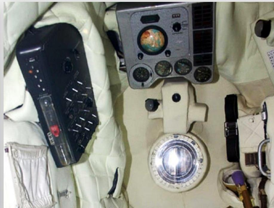
Внутренний вид кабины корабля "Восток". Слева - пульт управления. Впереди - приборная доска с устройством "Глобус". Под ним - иллюминатор с оптическим ориентиром "Взор".
